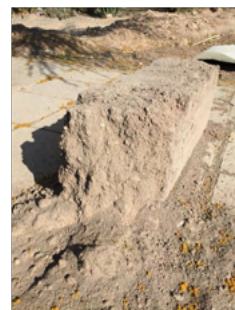
Figura 4. Agrietamiento en muros con suelo de Lerdo Durango.
