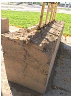
Figura 4. Agrietamiento en muros con suelo de Lerdo Durango.
