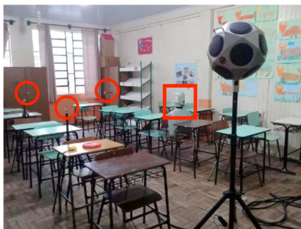
Figura 2 – Configuração com o posicionamento da fonte sonora, cabeça artificial – indicada pelo retângulo vermelho – e microfones distribuídos na sala de aula – indicados pelos círculos vermelhos. (Os autores, 2018).
