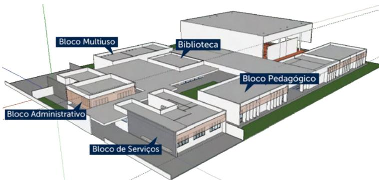
Figura 1 – Volumetria da tipologia arquitetônica para unidades de ensino fundamental de 9 salas de 1 pavimento.
