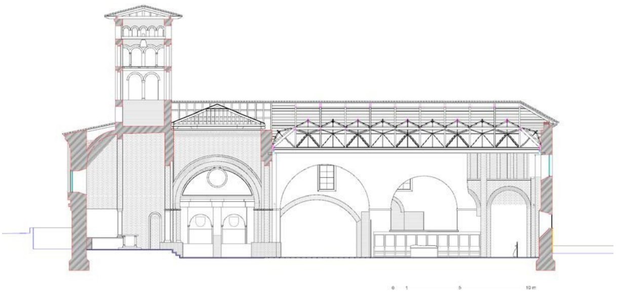
Fig. 6 Sección longitudinal de la iglesia con el nuevo diseño de casetones piramidales y armadura incorporados
