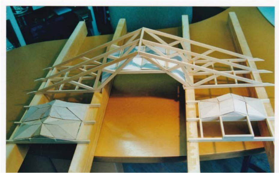
Fig. 3 Primera maqueta de la estructura resuelta con una cercha común para las tres crujiás, la central resuelta con casetones en forma piramidal y las laterales con casetones en formas más variadas.
