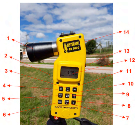
Figura 1. Definição dos botões do Criterion. Em que: 1. Lupa; 2. Gatilho; 3. UP; 4. Edit; 5. Back; 6. Mode; 7. Down; 8. Power; 9. Fwd; 10. Enter; 11. Hud; 12. Display; 13. Botões de ajuste de escala; 14. Ocular.
