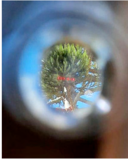
Figura 9. Impossibilidade de visualização da medição do diâmetro pela presença de galhos.
