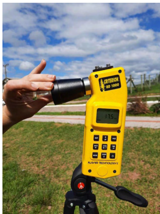
Figura 3. Lupa sendo adicionada ao Criterion RD 1000.
