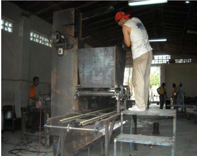
Foto1. Unidades de llenado de la máquina
