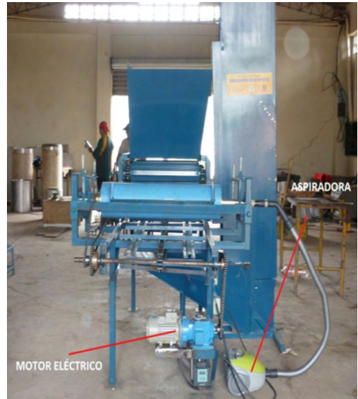
Foto 3. Ubicación del motor y de la aspiradora
