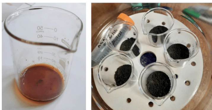
Figura 8 - Bio-óleo e biochar produzidos.
