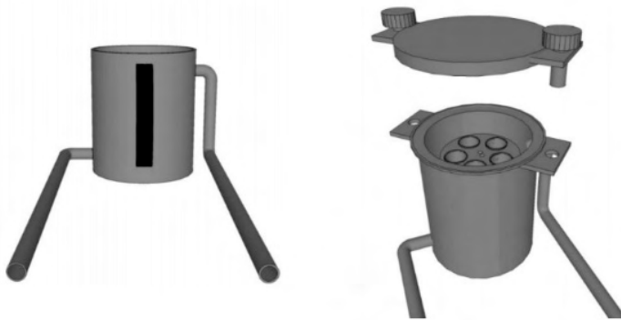
Figura 2 - Concepção inicial e final do reator de pirólise.
