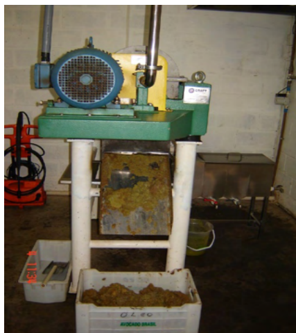
Figura 3. Polpa de avocado após trituração para encaminhamento para prensa e filtragem, Jaguacy Brasil, 2013.
