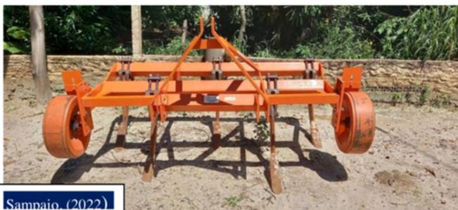
Figura 6. Subsolação em área de pastagem e subsolador de 05 hastes, Arealva (SP).
