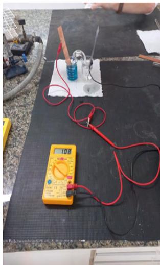
Figura 2 – Célula eletroquímica (Pilha de Daniell).
