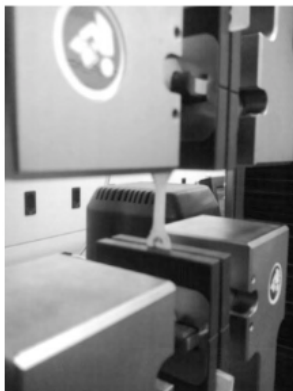
Figura 1: Ensaio de tração do adesivo (ASTM 638D, 2002).
