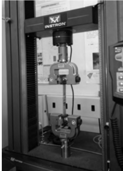
Figura 2 – Ensaio de tração das juntas de cisalhamento simples.
