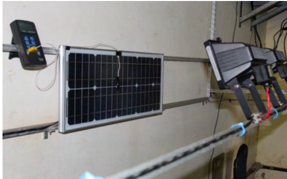
Figura 6: Plataforma desenvolvida para o Traçador de Curvas.
