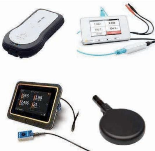
Figura 13 – (a) detector RTI, (b) fluke, (c) radical e (d) câmara de Ionização.
