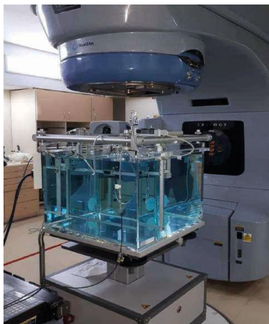
Figura 1 – Exemplo de fantoma cúbico 3D de varredura em um acelerador TrilogyTM.
