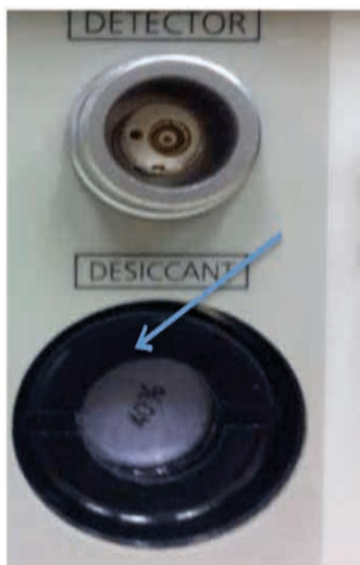
Figura 6 – Verificação da cor da sílica gel, um bom indicador das condições de umidade: quando a cor está azul, está correto, quando se torna rosa, a sílica precisa ser trocada ou regenerada numa estufa a 35 °C.
