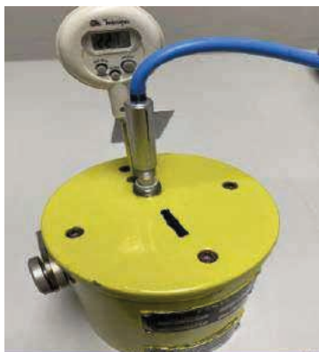
Figura 9 – Geometria do teste de estabilidade a longo prazo de uma câmara cilíndrica tipo Farmer PTW (2022) (com uma fonte teste de ^{137}\text{Cs} e com um termômetro inserido na cavidade do irradiador para ajustar sua resposta a uma temperatura ( ^{\circ}\text{C} ) ambiente e considerar o valor da pressão de referência.
