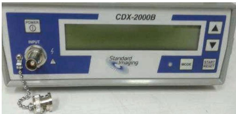
Figura 5 – Visão típica de um eletrômetro onde chama a atenção o protetor do seu conector de entrada, importante para preservar o sistema de umidade e poeira.
