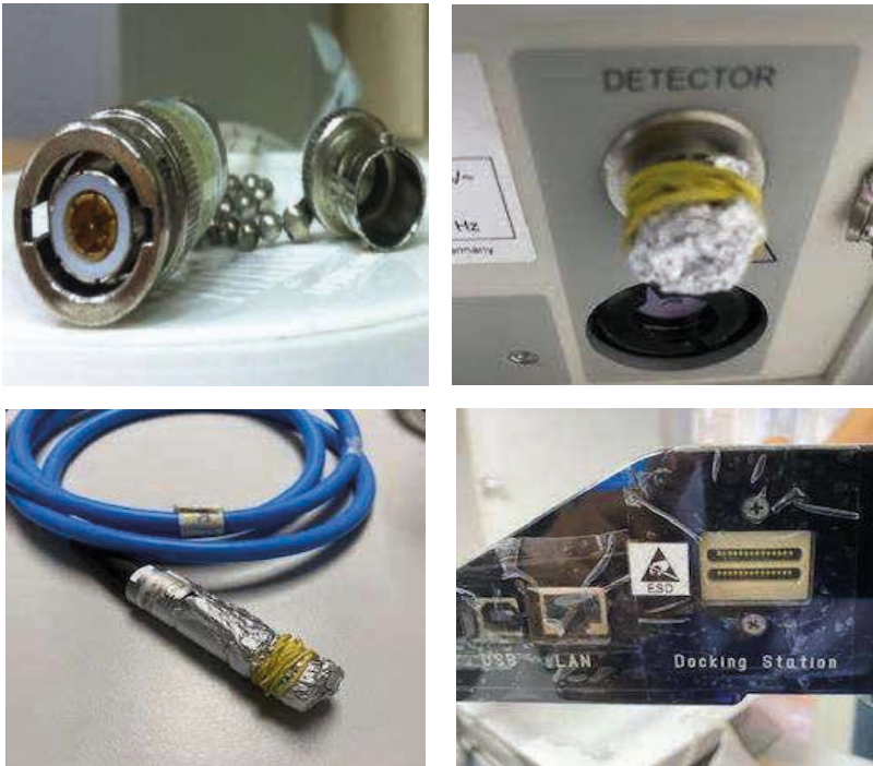
Figura 7 – Visão no sentido horário de um conector tri axial com sua capa metálica protetora; do conector de entrada no eletrômetro protegido com folha de alumínio; da extremidade de um cabo sem capa metálica, mas com proteções de alumínio; e da parte posterior do Quickchek protegido com tape em todas as entradas que possam ser caminho para umidade e poeira.
