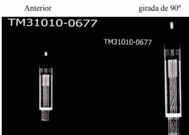
Figura 8 – Exemplo de uma radiografia típica nos planos anterior e lateral de uma câmara cilíndrica (as imagens mostram um alinhamento muito bom do eletrodo com o eixo da câmara).
