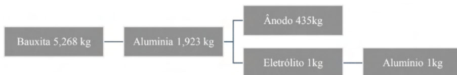
Figura 7 - Balanço de massa do processo de produção de alumínio primário.
