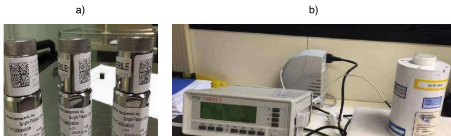
Figura 7 – a) Sementes calibradas pelo NIST ; b) Calibração de Camara Poço.
