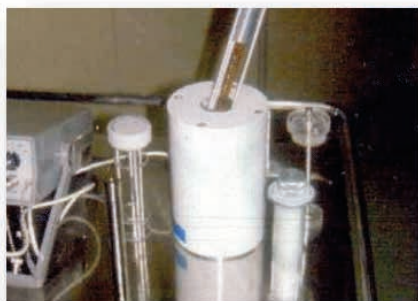
Figura 17 – Calibração de sementes com câmara poço.
