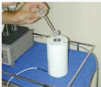
Figura 17 – Calibração de sementes com câmara poço.
