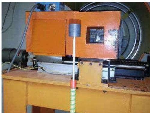
Figura 4 – Mostra o colimador adicional divergente e a câmara posicionada no centro do feixe de radiação da fonte de  $10 \times 10 \text{ cm}^2$  a 100 cm.
