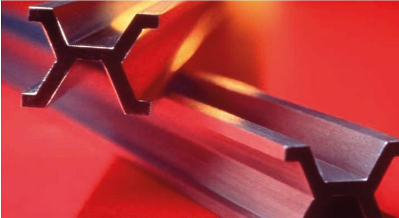
Figura 5 – Barra de platina-irídio do protótipo do metro.
