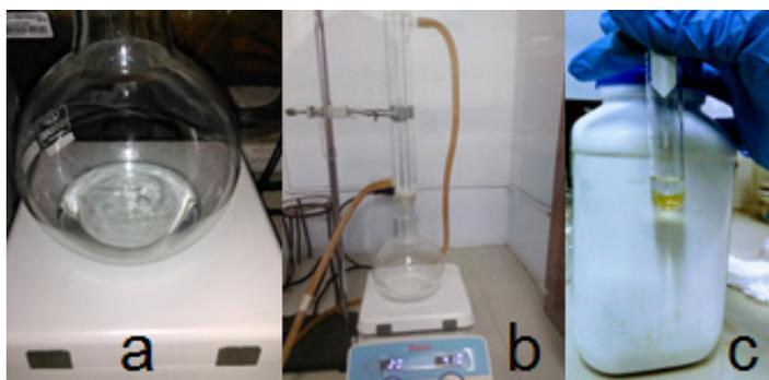
Figura 1: Secuencia de síntesis del polisiloxano a) Éter con diclorodimetilsilano b) Equipo de reacción a reflujo c) polisiloxano
