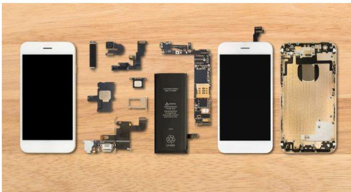
Figura 3 – Partes internas de um *smartphone*.
