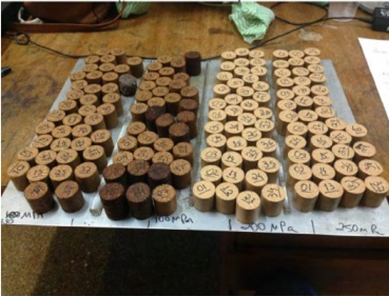
Figura 3. Típicos briquetes produzidos em diferentes pressões de compactação com ou sem a adição de sólidos carbonáceos.
