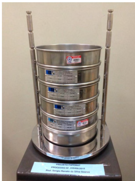
Figura 1. Agitador Eletromagnético para Peneira.
