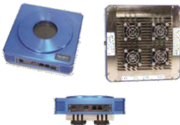
Figura 3: CCD RDS Alta 9000 utilizada para observar e registrar os debris espaciais.
