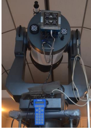
Figura 4: Telescópio Obelix [Meade 14'] com a CCD RDS Alta 9000 instalada, Observatório Abrahão de Moraes/IAG-USP.
