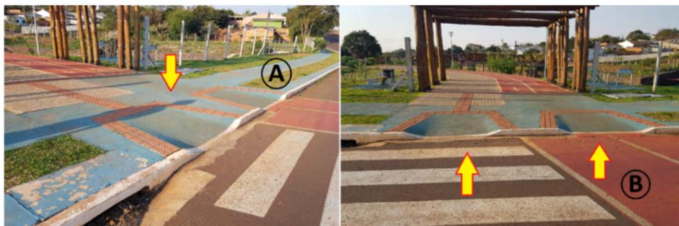
Figura 15: Calçadas com piso podotátil correto na zona C.
