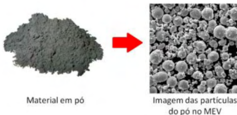
Figura 1 – Imagem detalhada do material metálico utilizado nos processos SLS e SLM (Marques, 2013)
