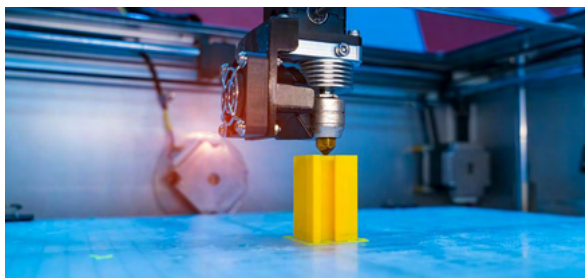
Figura 4 - Processo de manufatura aditiva através da Impressão 3D.
