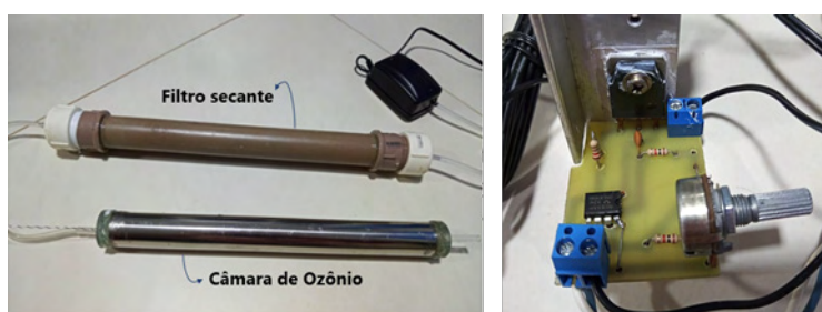
Figura 2- Na esquerda, Câmara de Ozônio e Filtro secante, a direita, Placa controladora de frequência, ambos componentes do Gerador de Ozônio.
