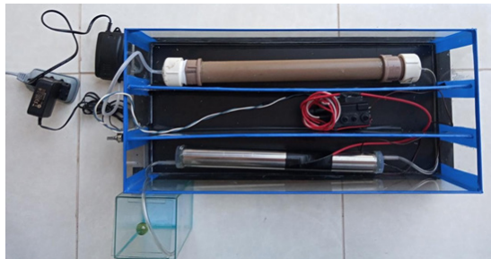
Figura 3 - Gerador de Ozônio finalizado.
