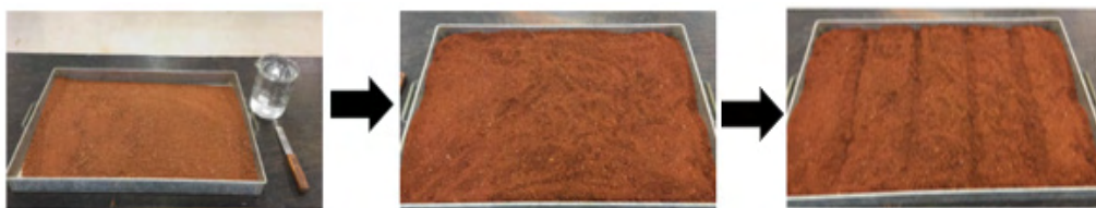
Figura 10 – Processo de preparação do solo úmido e partição.
