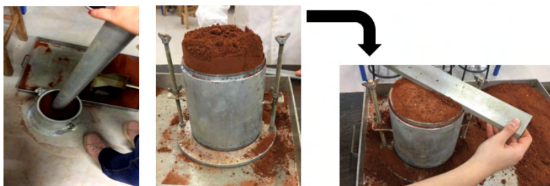
Figura 11 e 12 – Compactação, remoção do cilindro e amassamento do corpo de prova.
