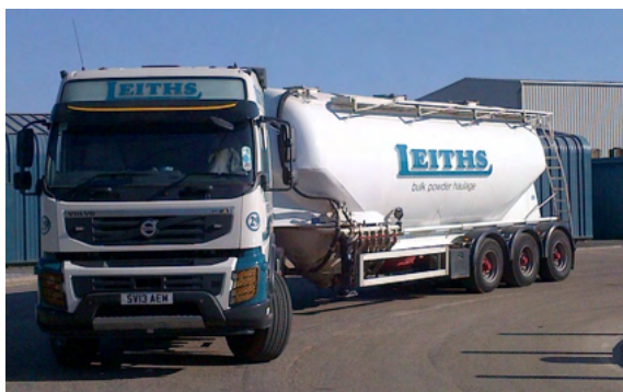
Figura 7. Silos móviles para productos en polvo.
