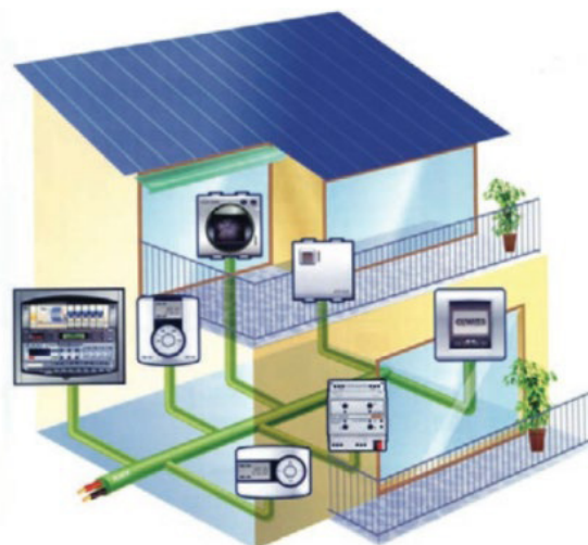
Figura 2 – Residência conectada em rede com cabeamento interno BUS (Barramento).
