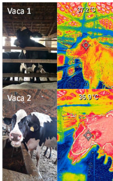
Figura 5 . Imagens termográficas da cabeça (lateral esquerda na altura dos olhos) no comprimento de onda do infravermelho e . Vaca 1, com os membros anteriores em cima do cocho e Vaca 2, com ofegação intensa, boca aberta e salivação.
