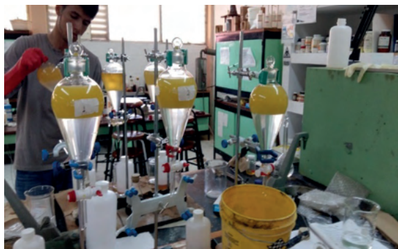
b) proceso del cuarto lavado del biodiesel
