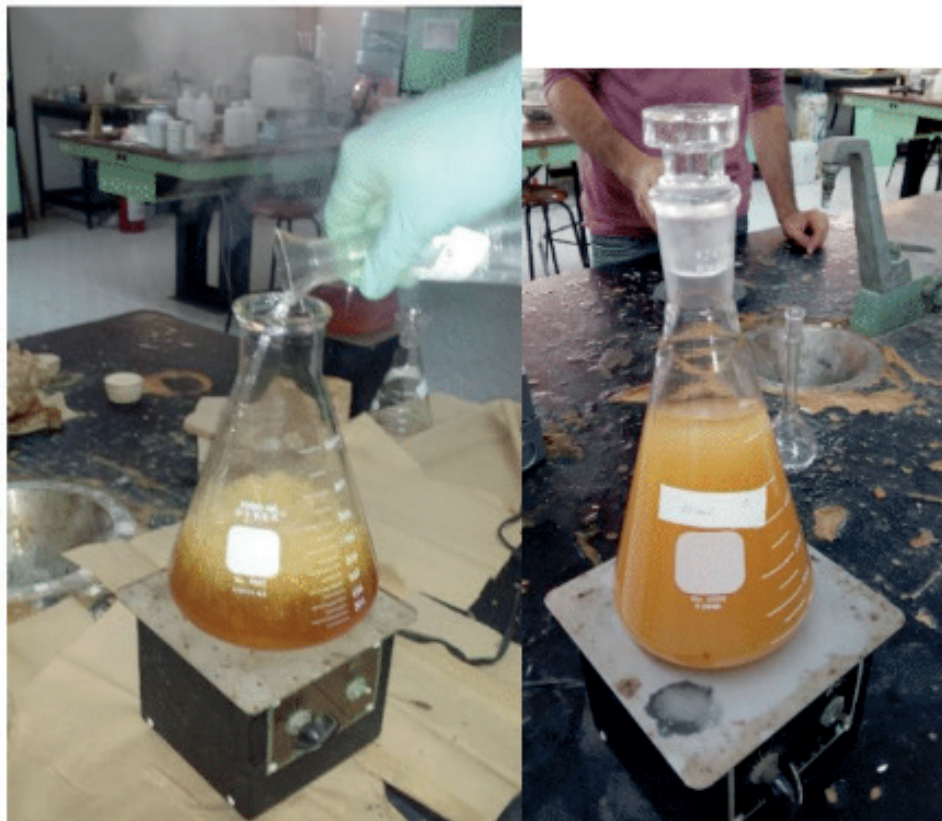
Figura 5 Proceso de Esterificación de los aceites comestibles usados, en la elaboración del biodiesel fuente propia
