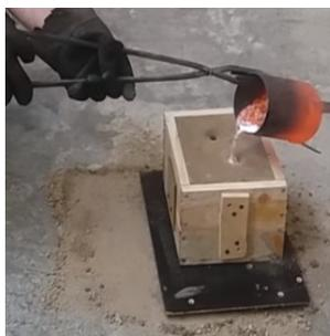
Figura 4: Preenchimento do molde negativo com alumínio derretido.
