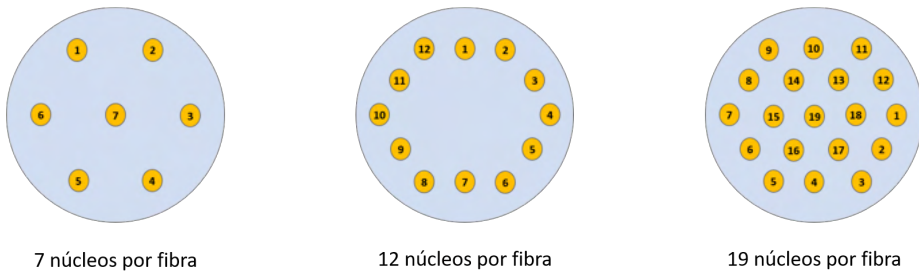
Figura 3.1: Fibras com 7, 12 e 19 núcleos.
