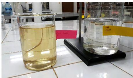
Figura 1: Comparação de água não tratada (esquerda) e água tratada apenas com sementes de moringa (direita).
