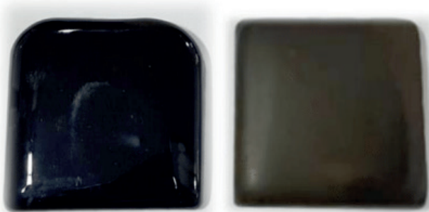
Figura 4. Monolitos de vidro e vitro-cerâmica obtidos a partir do resíduo U3M.
