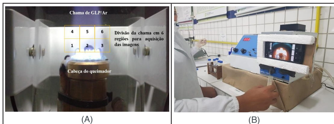
Figura 1. (A) Chama com as seis regiões escolhidas para estudo de sensibilidade na análise de Li; (B) Suporte utilizado para aquisição das imagens digitais utilizando o smartphone em um suporte confeccionado com materiais de baixo custo como isopor e papelão.
