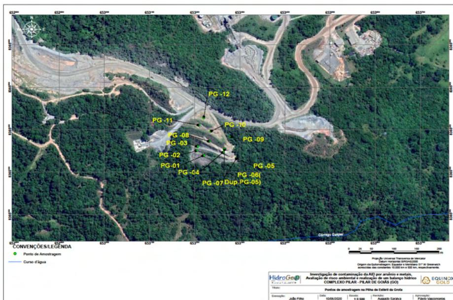
Figura 5: Localização dos pontos de amostragem na pilha de estéril da Grota.
