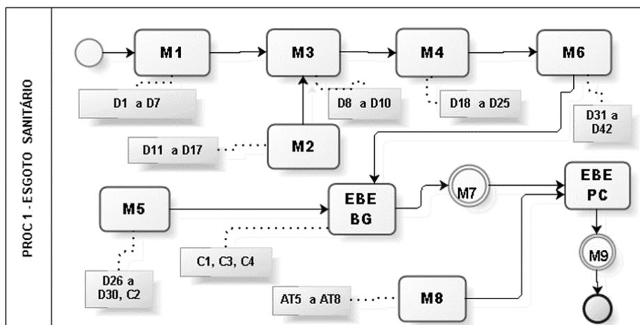
Figura 4. Fluxograma do trajeto dos esgotos sanitários nos Meso Setores através dos pontos M1 a M9 no SES PC.
