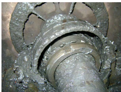
Figura 12 – Vista frontal do rolamento danificado.
