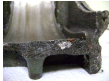
Figura 7 – Detalhe da face rompida
