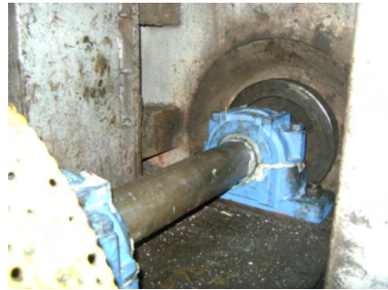
Figura 2 – Eixo e mancais do conjunto.
