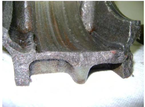
Figura 16 – Vista frontal do ponto de rompimento.
