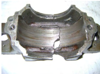
Figura 6 – Base mancal fraturado.
