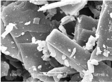
Figura 14. O material sólido da Amostra 3 foi metalizada com ouro por 5 mim com corrente de 30 mA e vácuo de 200 m Torr. As medidas foram realizadas com 20 e 30 Kv com magnificação entre 3.000 e 50.000 vezes
