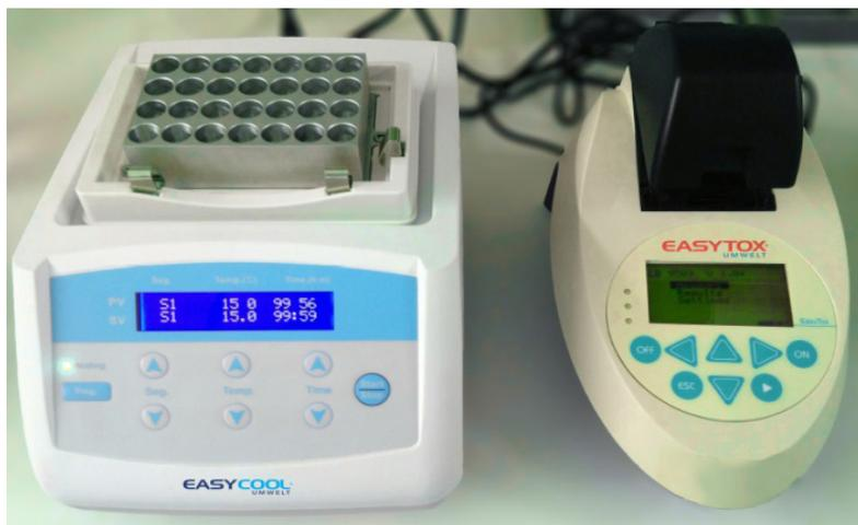
Figura 5-Sistema EasyTox ET-400 utilizado nos testes de ecotoxicidade.
