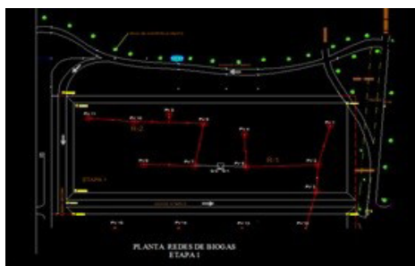
Imagen 3. Muestra de pozos de venteo sugeridos para el desarrollo del proyecto, para la celda en uso.
