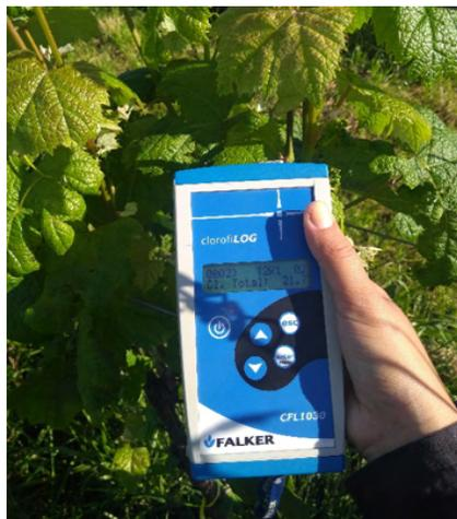
Figura 5: Avaliação de clorofila total nas folhas da Videira 'Tannat', utilizando o ClorofiLOG-CFL 1030, marca FALKER.
