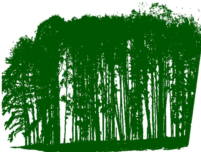
Figura 24 - Nuvem de pontos com remoção de outliers e pontos duplicados utilizando o aplicativo CloudCompare.
