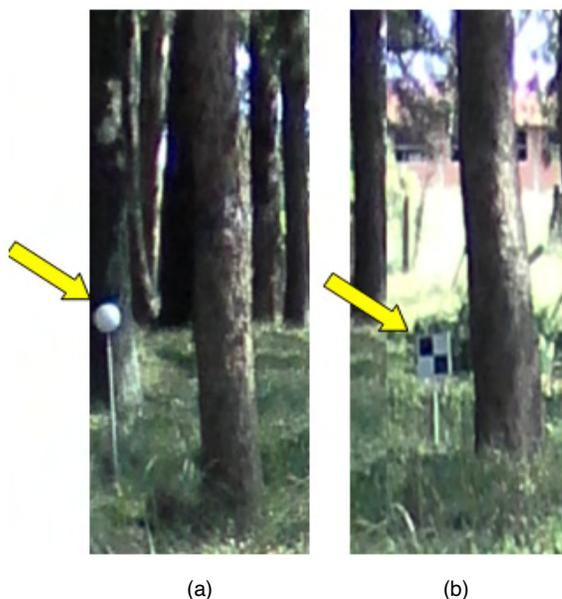
Figura 18 - Alvos utilizados no levantamento de dados. a) Alvo esférico; b) alvo plano.
