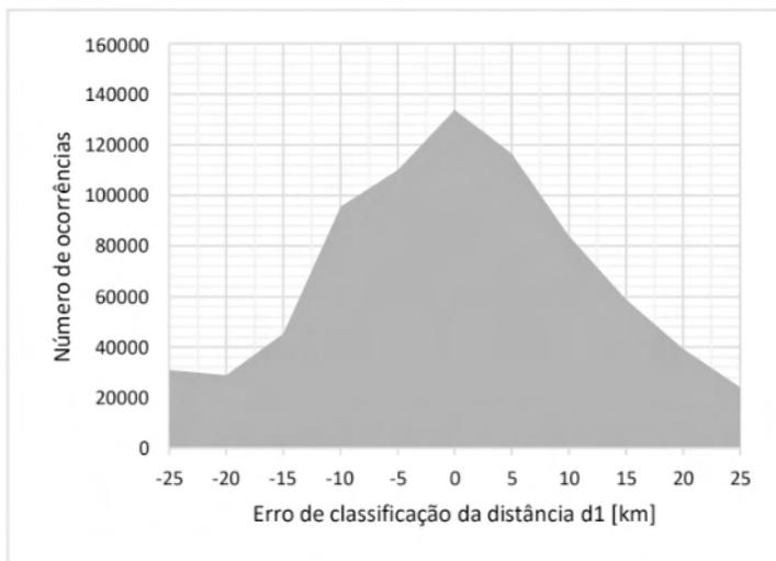
Figura 8 - Erro de estimação da distância da falta em função da impedância  $Z_1$  para o conjunto de dados de validação.
