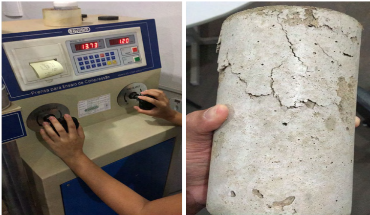
Figura 7 – Rompimento do corpo de prova
