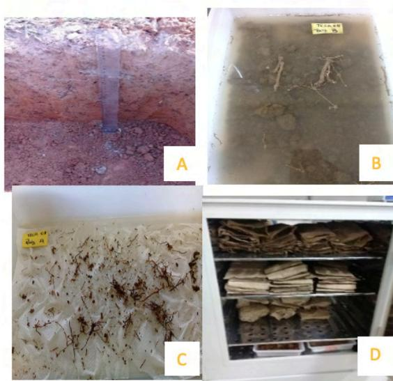
Figura 4. Abertura de trincheira (A); Lavagem das raízes (B); Separação (C); Secagem (D)
