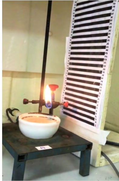
Figura 01 - Epirradiador, chama piloto e régua graduada.
