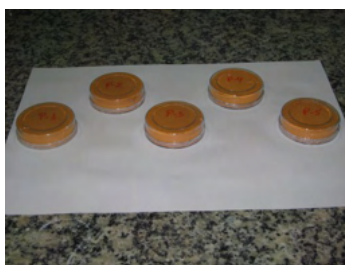
Fig 1: Porta-amostras usados na determinação da concentração de atividade de ^{226}\text{Ra} e ^{228}\text{Ra} em amostras de sedimento.
